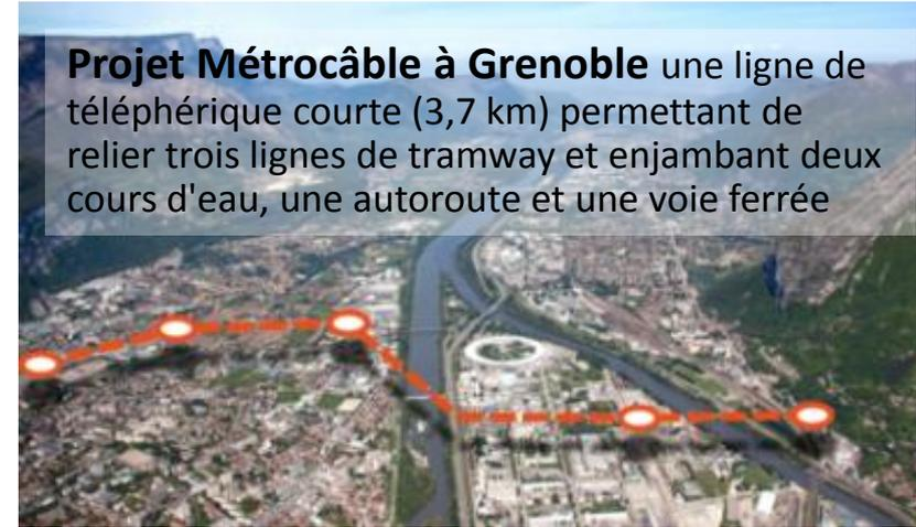
**Projet Métrocâble à Grenoble** une ligne de téléphérique courte (3,7 km) permettant de relier trois lignes de tramway et enjambant deux cours d'eau, une autoroute et une voie ferrée
